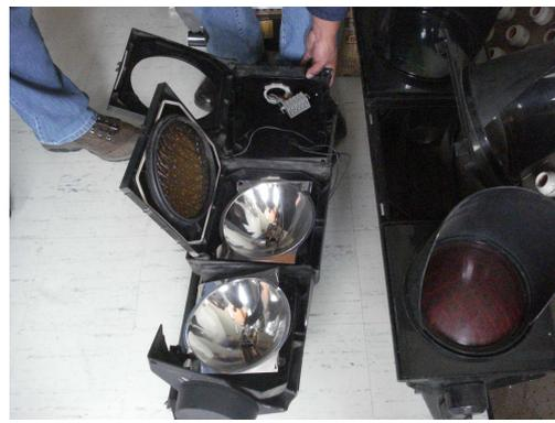
**La carcaza esta dividida en tres secciones una para luz roja, otra amarilla y una verde, se observa como encaja en la sección intermedia el modulo luminoso LED.**
