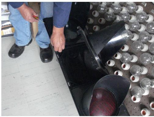
**Carcaza de semáforo donde habita el tipo de elemento luminoso para el funcionamiento de los semáforos.**
