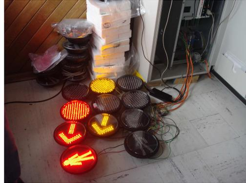
Las verificaciones se realizan bajo el software **sitrsffic** control y en versión 5 y donde se verifica el nivel de corriente para los cambios a rojo, el cual se programa en el momento en el que se instalan los LED
