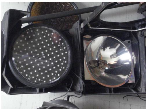
**Vista individual el LED instalado en la carcaza del semáforo.**
